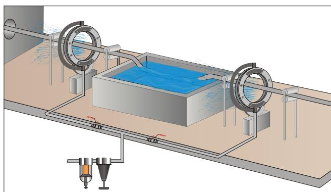
Ekstrüzyon profilleri ve otomotiv parçalarını temizlemek ve kurutmak için iki çeşit **20002 – 2"** Model Ring Blade™ Hava Süpürme Sistemi bulunur. Hava süpürüçülerin tasarımı, üfleme gücünün otomotiv parçalarındaki boşluklara girmelerini ve ekstrüzyon parçaların düzgün şekilde temizlenip kurutulmalarını sağlar. İşlem sırasında baloncuk oluşduğunda, Ring Blade™ Air Wipe açılabilir ve böylece baloncuk üretime zarar vermeden geçip gidebilir.
