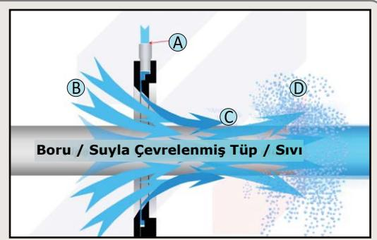
**Ring Blade™ Hava Süpürücü**, eloksallı alüminyumdan üretilir ve 5 standart boyda bulunur: 1" (25.4 mm), 2" (50.8 mm), 3" (76 mm), 4" (102 mm) ve 6" (152 mm). Uzun ömürlü kullanım için eloksallı alüminyumdan üretilen gövde, paslanmaz çelik şim ve paslanmaz çelik civatalar BÜTÜN Ring Blade™ Hava Süpürme sistemlerinde standart olarak verilirken, rakip ürünlerde ayrıca ücretlendirilirler. Hava Süpürme sistemlerinin 2 çeşidi bulunur:
